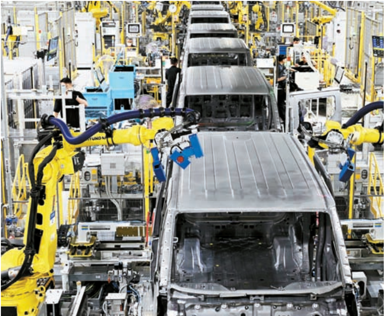
지난해 11월 문을 연 기아의 화성 ‘이보 플랜트(Evo Plant)’ 공장 전경. 산업용 로봇을 융접 작업에 전면 투입했다.
