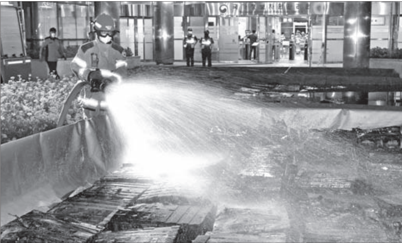
수조에 담긴 리튬이온 배터리 대전시 유성구 국가정보자원관리원 화재 현장에서 수거해 소화수조로 옮긴 리튬이온 배터리에 지난 27일 오후 소방대원이 물을 뿌리고 있다. [연합뉴스]
